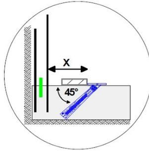
2. Die Platte des Kombi-Fix soll plan auf dem Ortbeton aufliegen
