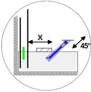
1. Den Abstand von der Bewehrung zur Ankerstelle einmessen und Kombi-Fix mit Kombi-Hülse TITAN in den frischen Beton eindrücken
