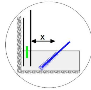
3. Nach dem Aushärten den Kombi-Fix entfernen und Gewindestab über die gesamte Länge in die Kombi-Hülse TITAN einschrauben
